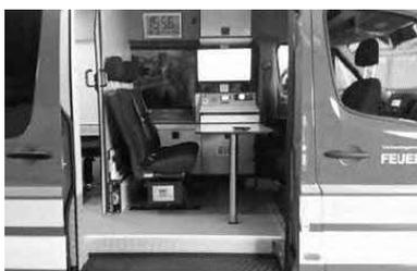
Der Bildschirmarbeitsplatz ist ständig mit der Feuerwehr Einsatzzentrale (FEZ) in Bacharach verbunden, so dass jederzeit der Austausch von Daten zwischen FEZ und ELW 1 möglich ist. Sämtliche Einsatzunter-
