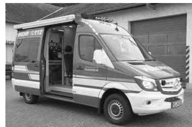
Der ELW 1 dient bei Einsätzen zur Unterstützung der Einsatzleitung. Das Fahrzeug ist mit zwei Funkarbeitsplätzen, einem weiteren Bildschirmarbeitsplatz und einem kleinen Besprechungsraum, in dem vier Personen Platz finden ausgestattet.
