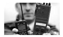
beschafft und an die Feuerwehren verteilt. Im Rahmen von Übungen wurden erste Erfahrungen mit der neuen Technik und den neuen Geräten gesammelt. Geplant ist, bei kleineren Einsätzen die neuen Digitalfunkgeräte für den Einsatzstellenfunk anstelle der alten, analogen 2 m Geräte einzusetzen.
